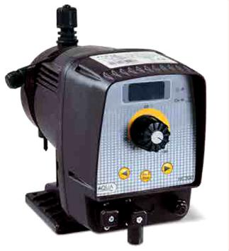
در زمان کارکرد پمپ ، چراغ سبز رنگ نشان دهنده فعال بودن دستگاه بوده و چراغ قرمز رنگ بر اساس سرعت دوز تنظیم شده روشن میشود . در صورت مجهز بودن دستگاه به قابلیت تشخیص کاهش مقدار ماده شیمیایی (سنسور کنترل سطح) ، چراغ سبز رنگ به رنگ نارنجی درآمده و با افزایش مقدار مواد به سطح نرمال مجددا سبز می شود .
